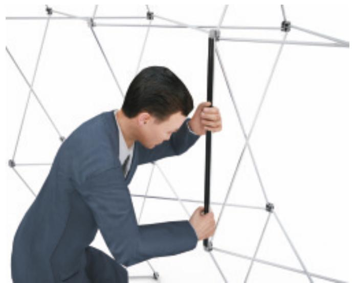
2.4. После установки всех 18 ребер, осадите конструкцию, приложив усилие к каждому из верхних кронштейнов стенда до тех пор, пока все ребра в вертикальных рядах не войдут до упора в соответствующие кронштейны.
